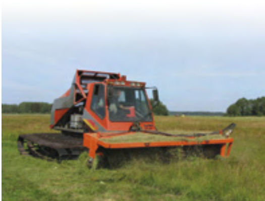
Ett slåtteraggregat har monterats på en omgjord pistmaskin.
