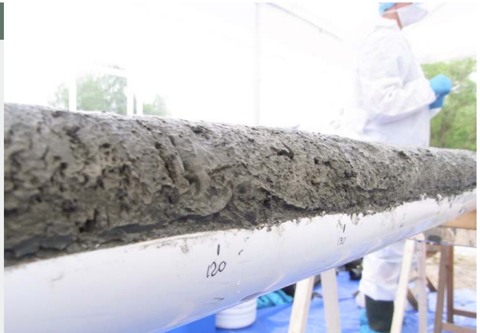
Provtagning av en 6 meter lång sedimentkärna från Mälaren.
